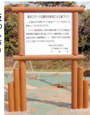
A-44 木製案内看板 H2000×W1340 杉・タナリス防腐注入 表面保護塗料塗布 (市民公園・千葉市)
