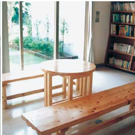
B-13 テーブル L2400×W800×H700 桧・ウレタンニス塗布 B-14 ベンチ L1400×W400×H400 桧・ウレタンニス塗布 (野鳥の森・館山市)
